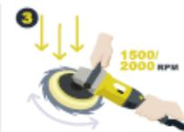
Usare un tampone di lana a velocità 1500-2000rpm ,applicare una moderata pressione
